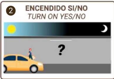
Encendido en caso de que la iluminancia sea inferior a 30 lx (modo día), o encendido directo (según programación). The luminaire turns on when the light is less than 30 lx (day mode). Or it can be always set it as on (setting the daylight sensor).
