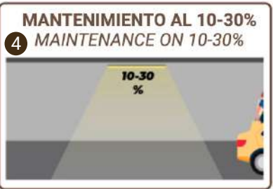
Encendido permanente al 10% o 30% una vez transcurrido el tiempo de iluminación al 100%. Standby dimming at 10% or 30%.
